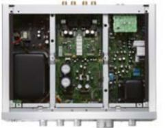
A-70は3分割シャーシ構造。クラスDアンプながらフルサイズコンポとし、音質のためにパーツ類をフラットに配置
